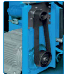
Courroie d'entraînement Poly-V
